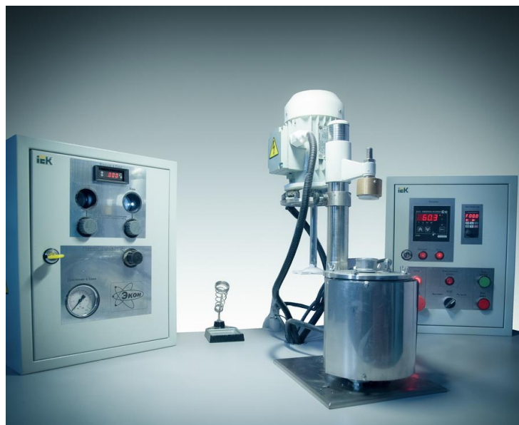
Рисунок 12 – Установка для горячего шликерного литья ЭКОН УГШЛ
