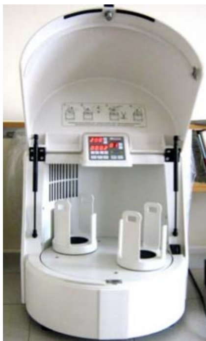
Рисунок 10 – Планетарная мельница Pulverisette 5
